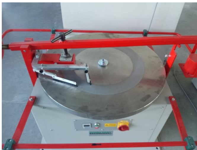
Obrázek 2: Zkouška odolnost proti obrusu metodou Böhme
