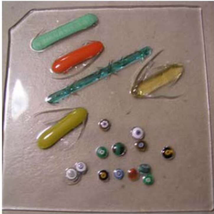
Obr.4.4-1: různá teplotní roztažnost
