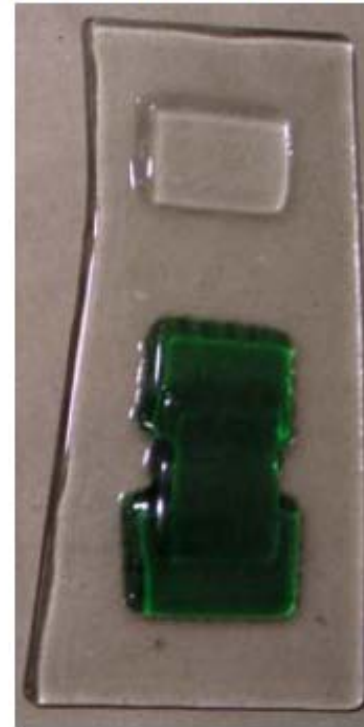
Obr.4.4-2: stejná teplotní roztažnost
