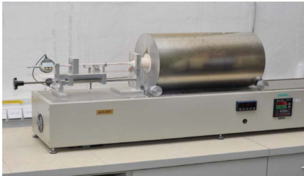
Teplotní dilatometr Clasic – 1500 °C – regulace TEMP, DELAY, RAMP
