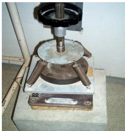
Obr. 6: Fotografie zkušební aparatury pro zkoušku dynamické tuhosti
