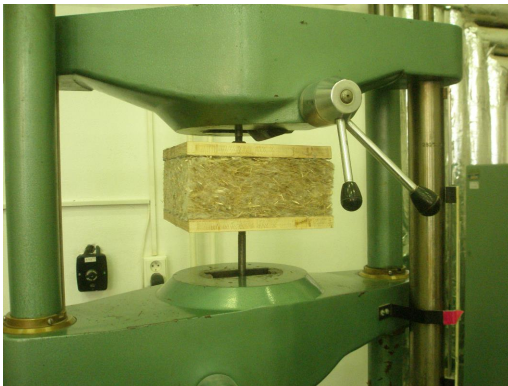
Obr. 10: Vzorek upevněný v lisu před zkouškou pevnosti v tahu kolmo k rovině desky
