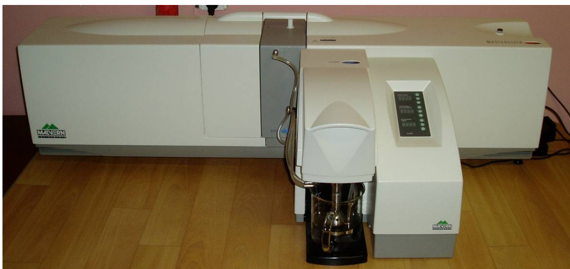
Obr. 2.1 : Přístroj pro stanovení velikosti a distribuce částic menších než 2 mm – Malvern Mastersizer 2000E System EPA5011
