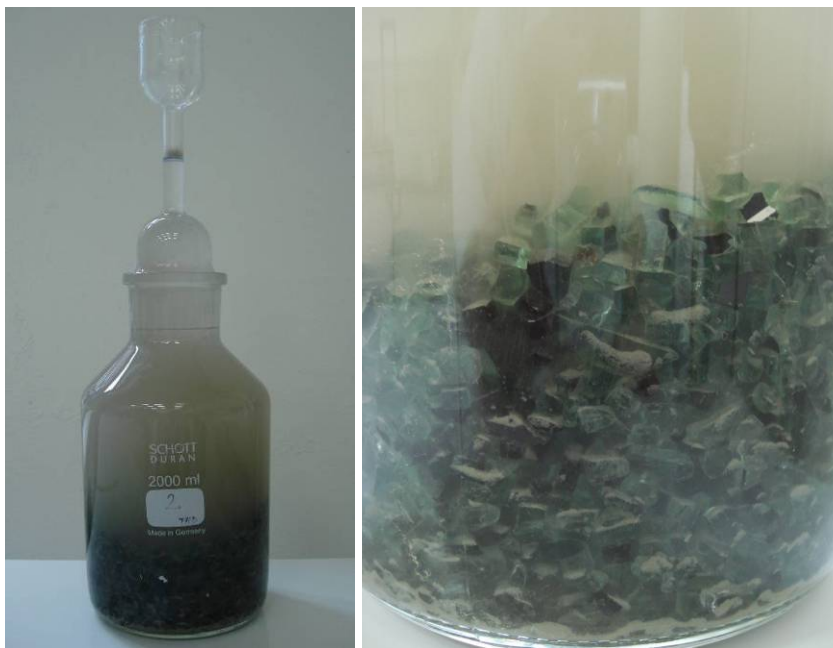
Obr. 2.2 : Pycnometrické stanovení objemové hmotnosti recyklovaného skla – pycnometr naplněný vzorkem a vodou (vpravo – detail vzorku)
