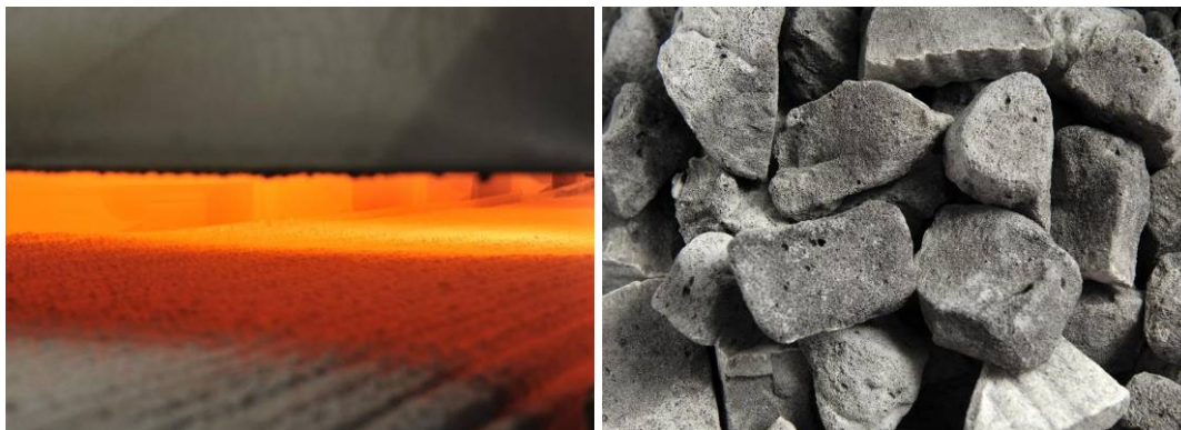
Obr. 7.2 : Výpal pěnového skla v peci (vlevo), pórovité kamenivo (vpravo) [16]
