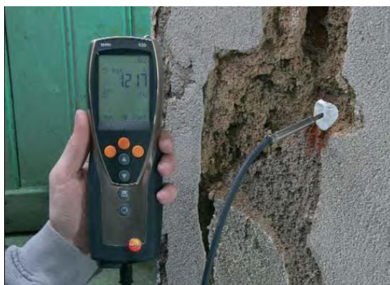
Fotografie přístroje Testo 635 s vlhkostní sondou
