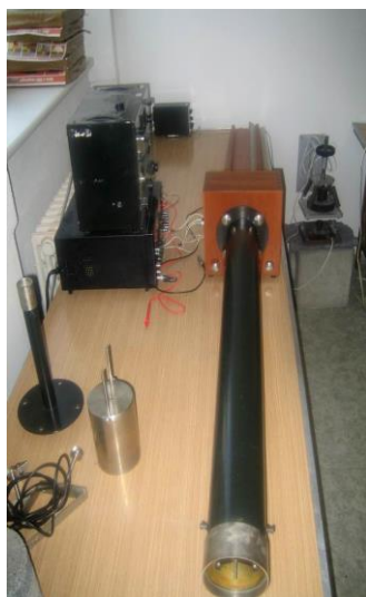
Obr. 14: Kuntova trubice: (1 - generátor; 2 - analyzátor; 3 - trubice; 4 - držák vzorku; 5 - sonda; 6 - mikrofon; 7 - reproduktor; 8 - vzorek; 9 - píst (dno) držáku; 10 - vzduchový polštář) [1]
